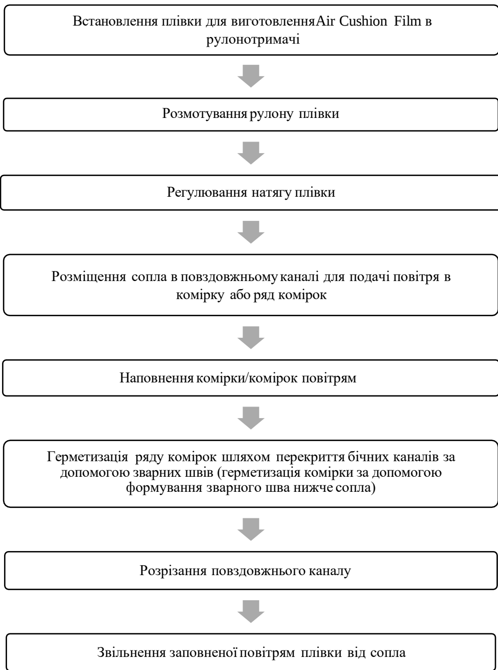
Рис. 10. Характерна технологічна схема формоутворення Air Cushion Film без зворотних клапанів за допомогою спеціального обладнання Air Cushioning Machine
