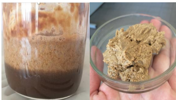
Рис. 1. Гідрофуз у процесі розщеплення та жирні кислоти, одержані з нього
