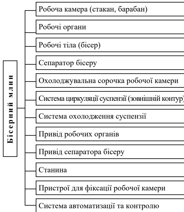
Рис. 11. Структура бісерного млина
