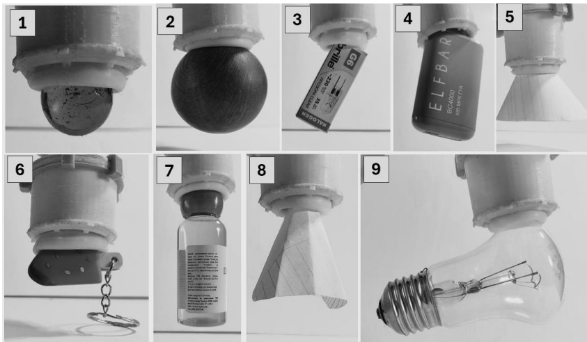
Рис. 5. Способи утримання різних за формами та матеріалами об'єктів біонічним пристроєм захоплення: 1 — скляна куля; 2 — дерев'яна куля; 3 — упаковка з картону; 4 — гладкий пластиковий корпус; 5 — паперовий конус; 6 — резиноподібне покриття; 7 — пластикова місткість з рідиною; 8 — паперовий багатокутник; 9 — гладка скляна поверхня
