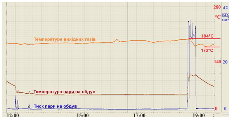
Рис. 4. Графік температури відхідних газів та вплив обдувки поверхонь нагріву на процес теплопередачі
