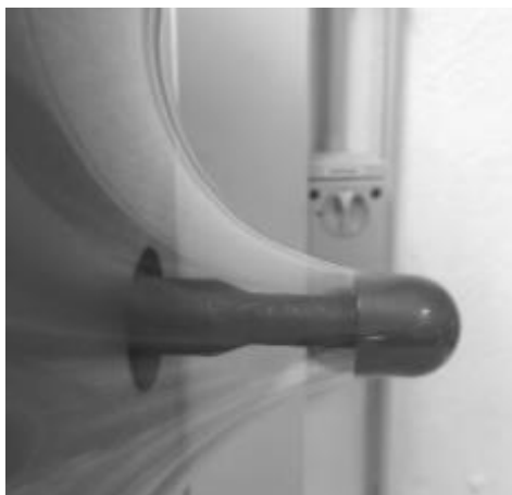
Рис. 5. Зразок плівки при визначенні зусилля утримання плівкою
