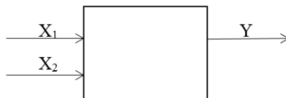
Рис. 2. Вплив зовнішніх факторів на формування зображень у системах зчитування коду: x_1 ( l_1 ) — відстань від пляшки до камери, мм; x_2 ( l_2 ) — розмір QR-коду, мм; Y — час зчитування камерою QR-коду, с
